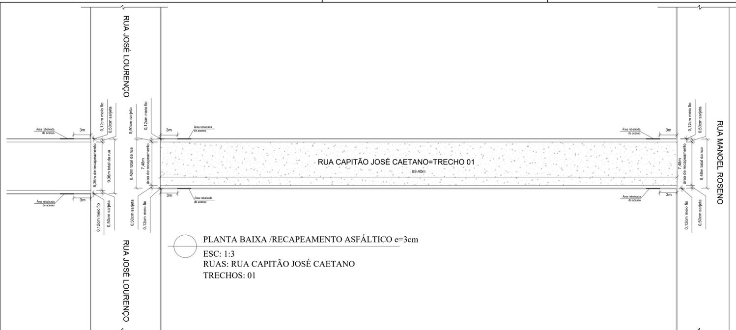
PLANTA BAIXA /RECAPEAMENTO ASFÁLTICO e=3cm
