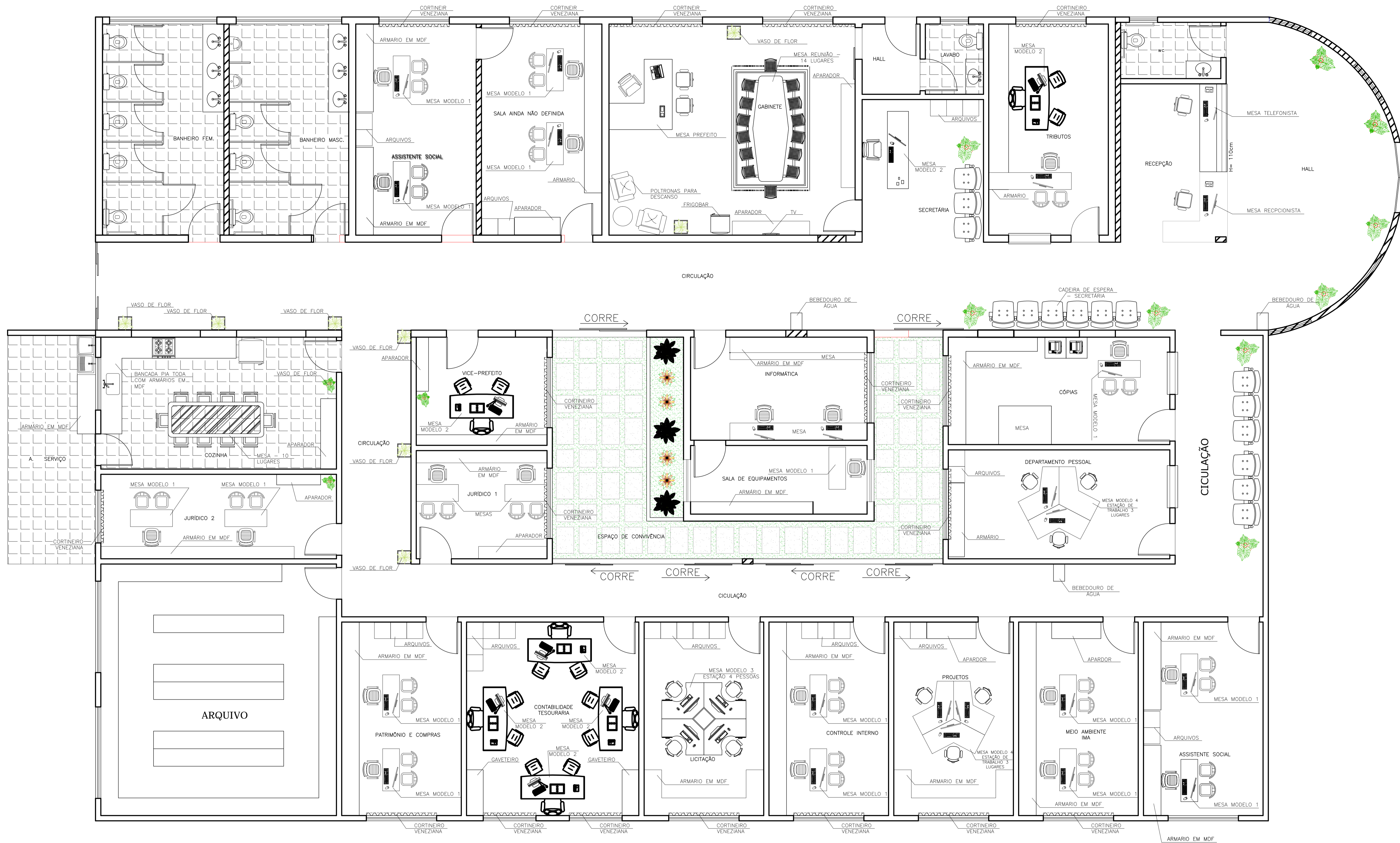
PLANTA LAYOUT ÁREA CONSTRUÍDA: 788,35m ESC 1/50
